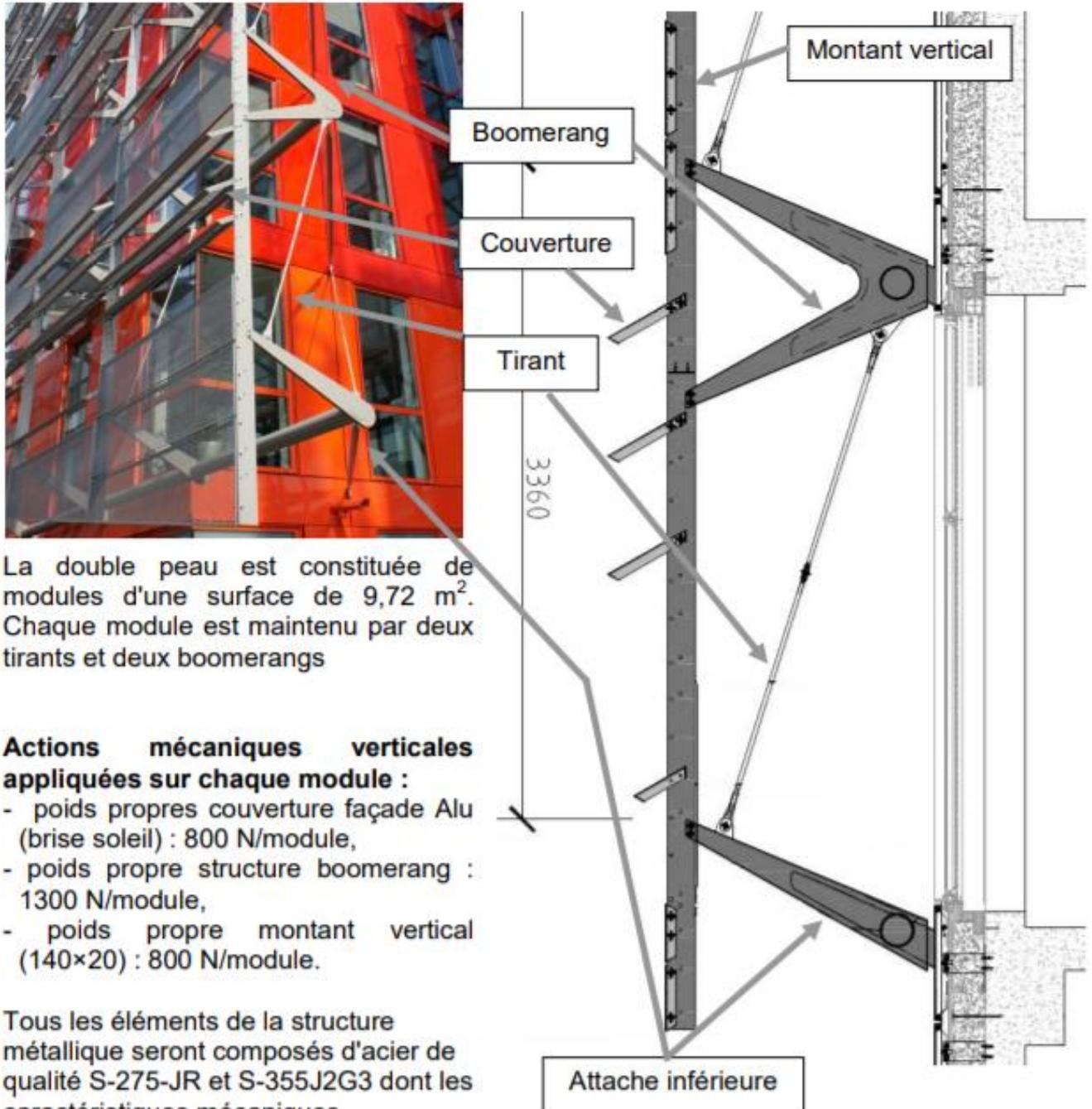
La double peau est constituée de modules d'une surface de  $9,72 \text{ m}^2$ . Chaque module est maintenu par deux tirants et deux boomerangs
